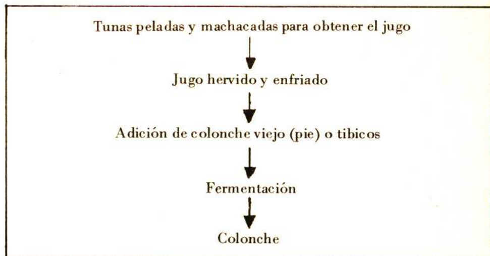
Figura 7. Diagrama de flujo del proceso de elaboración del colonche.
